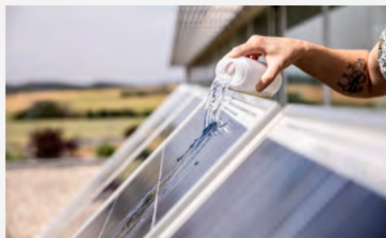
Efecto hidrofílico sobre panel tratado
