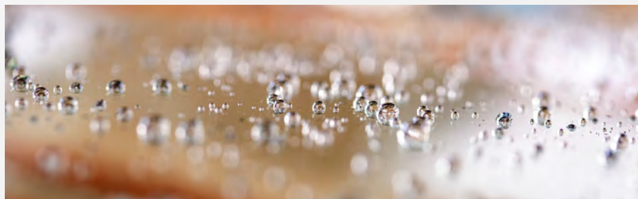
Ejemplo de efecto hidrofóbico de TECNADIS GWR sobre una luna de coche
