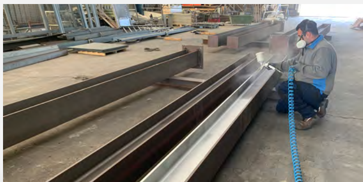
Ejemplo de aplicación de Tecnadis Multicoat Anticorrosión (Primer) sobre superficie ligeramente oxidada.
