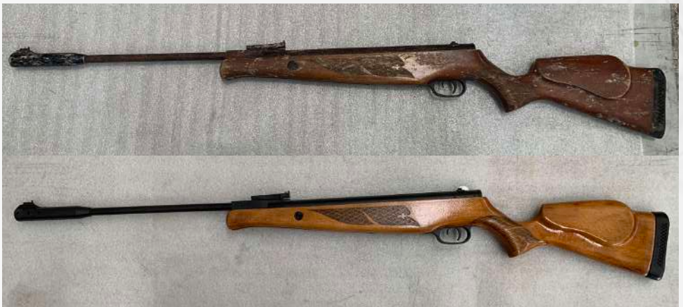
Ejemplo de restauración de arma con TECNAN BLUE (Negro mate). La foto de arriba antes del proceso y la foto de abajo muestra el resultado final.
