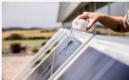
Efecto hidrofílico sobre panel tratado
