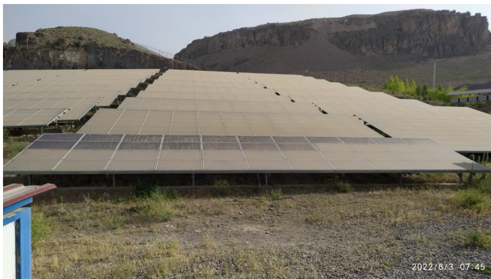
(Imagens tiradas após tempestade de areia em um teste com 18 painéis tratados – Turquia, Março 2022)
