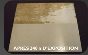
\* Étant donné qu'il s'agit d'un matériau résistant à la corrosion, AISI 304, dans le but d'accélérer l'essai et le processus de corrosion, les tôles ont été soumises à un choc thermique antérieur.
