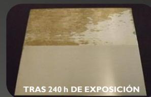
\* Debido a que se trata de un material resistente a la corrosión, AISI 304, con el objetivo de acelerar el ensayo y proceso de corrosión, se sometieron las chapas a un choque térmico previo.
